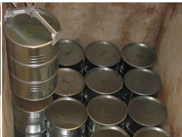
K.2 - 2. ábra Újracsomagolt hulladékok elhelyezése
