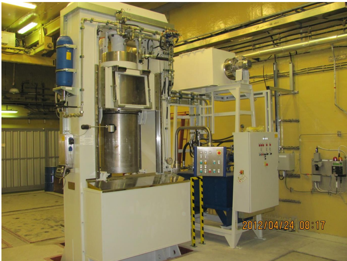
D.2.4 – 2. ábra Hulladéktömörítő prés
